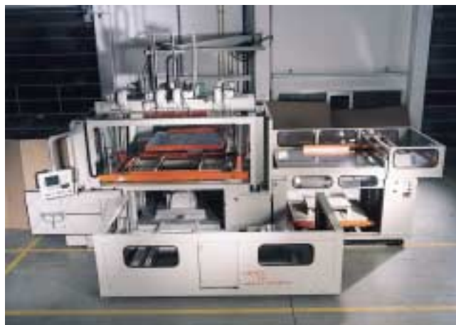
Bild 1. Vakuumtiefzieh-anlage mit Vorrichtungen zur Stapelverarbeitung (rechts) sowie für automatischen Werkzeugwechsel (vorn) (Foto: Maschinenfabrik Georg Geiss, Seßlach)
