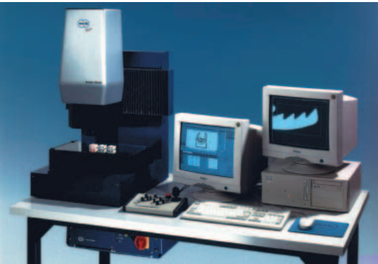
Bild 3. Multisensor-Koordinatenmessplatz für Messbereiche bis 400 mm (Foto: Werth Messtechnik GmbH)
