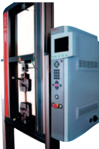
Bild 4. Eine Materialprüfmaschine bietet ein modulares Konzept bei hochauflösender Längenänderungsmessung (Foto: Zwick GmbH & Co.)
